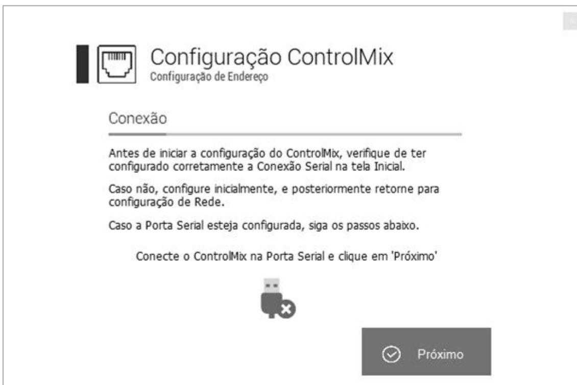
A tela de 'Configuração' deverá apresentar o ícone de conexão realizada com sucesso. Caso apresente o ícone de erro, verifique a conexão com o ControlMix e tente o processo anterior novamente.
