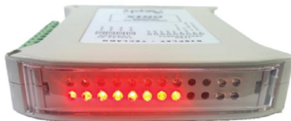
RL-01 RL-02 RL-03 RL-04 RL-05 RL-06 RL-07 RL-08 LEDs indicativos de saída atuada
