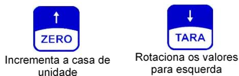
Durante o processo de incremento e decremento é possível visualizar o estado final do equipamento com a configuração. Após a escolha da configuração pressione IMPR para salvar a configuração.
