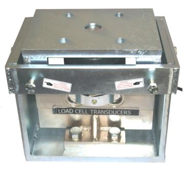
to, torções e forças paralelas ao plano de fixação do conjunto, equivalendo a uma rótula perfeita que fornece plena liberdade de movimento nos 3 eixos coordenados (X, Y, e Z). Provida de Coifa de borracha com presilhas que impedem a penetração de pós e particulas que possam gerar "calos" descentralizando a força aplicada no eixo de leitura da célula com consequente erros de peso no decorrer do seu uso, geralmente presentes em outros
