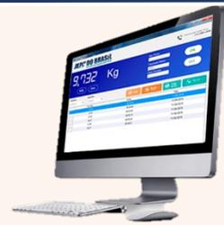
**Software VisionCollector** destinado a coleta de dados através de protocolos AEPH. Trabalha em conjunto com o Indicador de Pesagem (Matrix, Orion ou Onix), no qual o software será o Mestre e o Indicador o Escravo (RS232 ou RS485), possibilitando a coleta de valores de pesagem em função: -Tempo; -Variação; -Pico;
