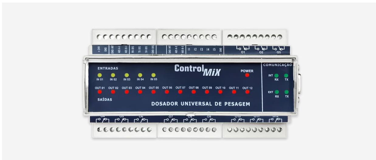
O controlador de processos de pesagem **ControlMix** é um equipamento eletrônico de elevada performance destinado a controlar todo o tipo de elemento gerenciável, periféricos a uma balança ou sistema de pesagem que se vincula a uma balança na entrada e/ou na saída de produtos pesados ou a serem pesados, tais como: processos de dosagens, envases, controle de transportadores e controle de máquinas em geral, proporcionando precisão e velocidade de comutação.
